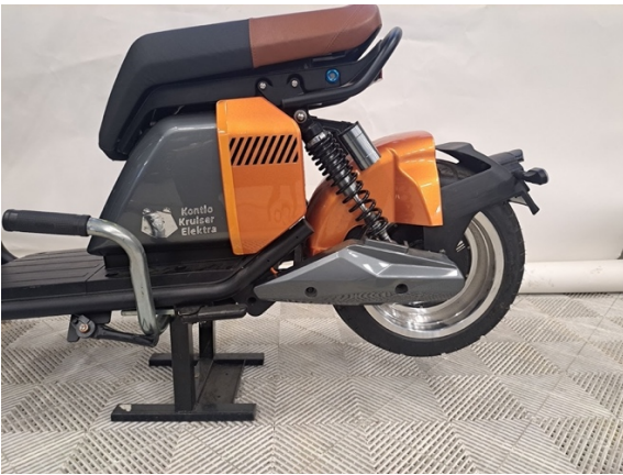
Nosta laitteen takapää korokkeelle.
